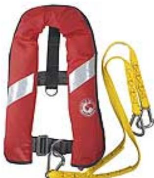
Grâce au nouveau système Hammar le gonflage automatique a été optimisé, de sorte à maintenir immédiatement le corps et la tête au-dessus de l'eau. Déclenchement par la pression hydrostatique et non par l'entrée d'eau ou l'humidité. Pas de risque de gonflage intempestif. Gonflage extrêmement rapide même par températures très basses. Cartouche de gaz de la chambre de gonflage protégée contre la corrosion. Frais de maintenance réduits
